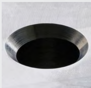
Senkung mit spiralisiertem Kegelsenker
